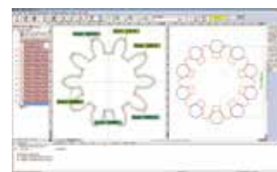
Příklad porovnávání kontury ozubeného kola a analýza průměru přes zuby.
