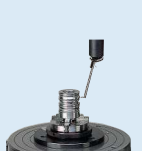
Měření rohovým dotekem
