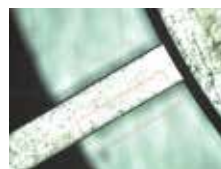
Pozitivní detekce hrany koaxiálním světlem
